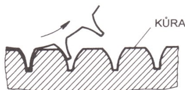
Obr. 8.6 Vytváření prohlubně od trnů profilového běhounu umožňuje průchod vzduch a vody ze zhutňované zeminy
