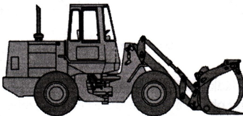
Obr. 6.8 Drapákové zařízení pro nakládku a přemísťování kusových materiálů
