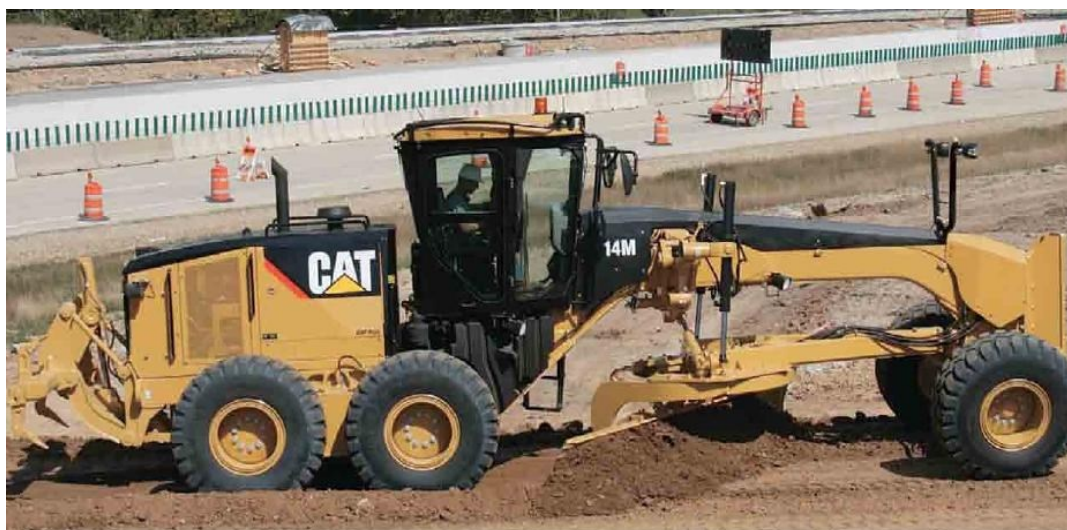
Obr. 5.22 Tříosý grejdr – Caterpillar 14M
