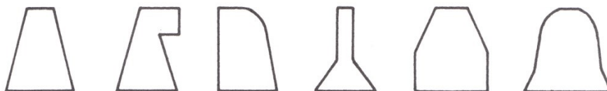
Obr. 8.5 Druhy trnů u profilových válců
