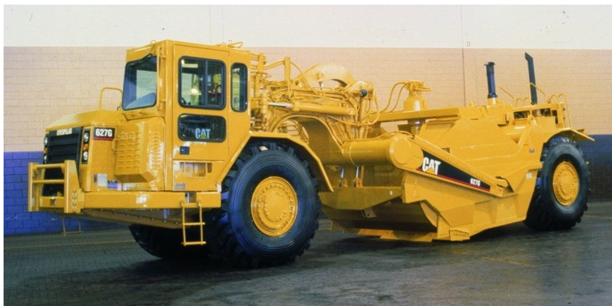
Obr. 5.14 Dvumotorový skrejpr – Caterpillar 627G
