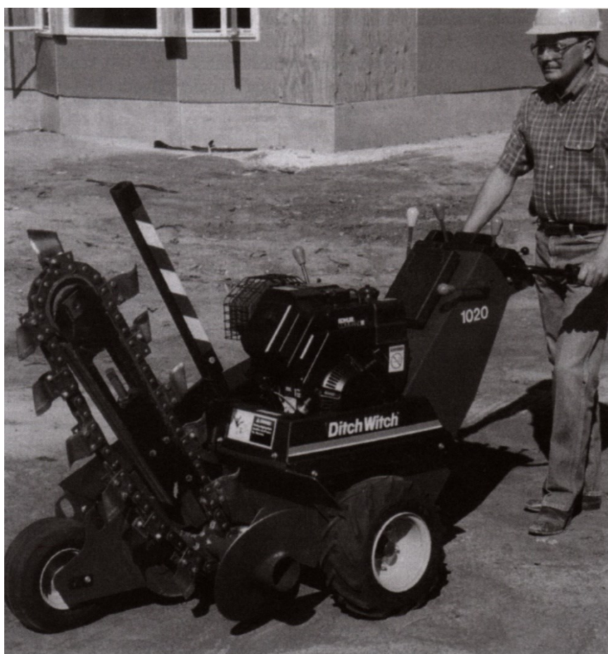
Obr. 3.44 – Ručně vedený řetězový rýhovač – Ditch-Witch
