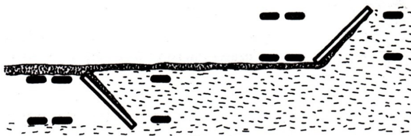
Obr. 5.26 Práce grejdru na dva záběry, ze kterých vytvoří ve středu společnou hrázku
