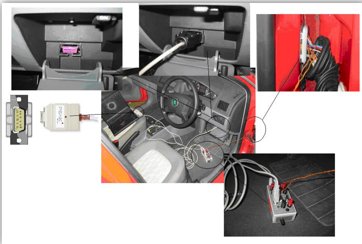
Obrázek 88 Realizace připojení na sběrnici CAN komfort u vozu Škoda Fabia.
