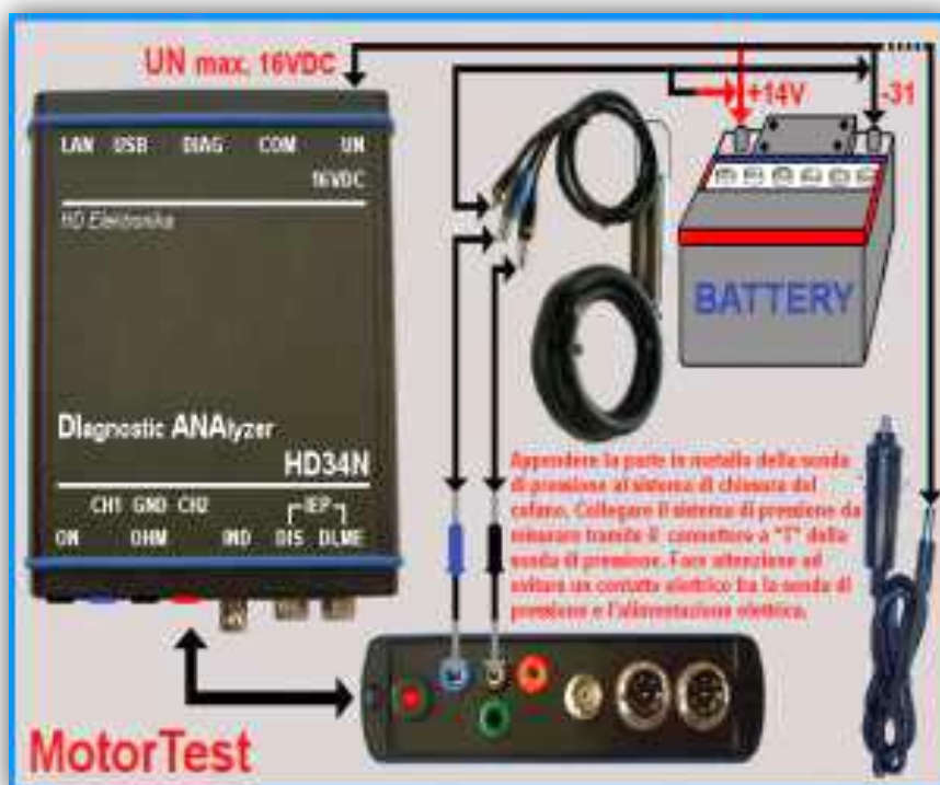
Obrázek 172 Propojení sondy s osciloskopem
