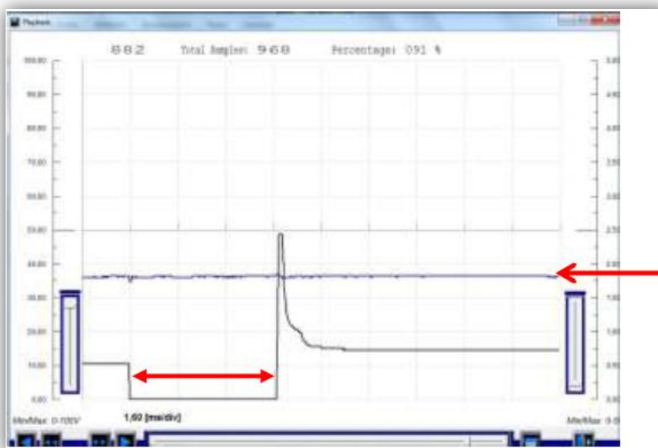
Obrázek 177 Pokles tlaku = větší doba vstřiku
