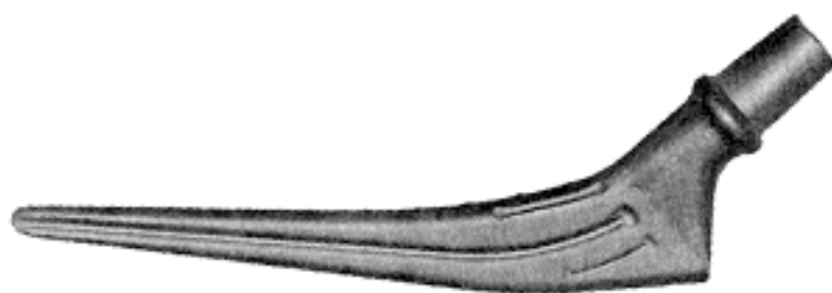
Obr. 7.6 Kyčelní endoprotéza vyrobená z kompozitu uhlík – uhlík
