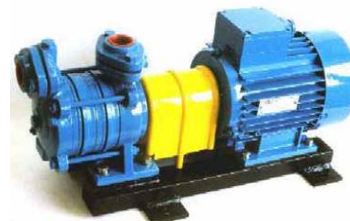
Obr. 3.20 Malé dvoustupňové čerpadlo – druhý stupeň je nalevo ve vloženém válcovém tělese sevřeném svorníky
