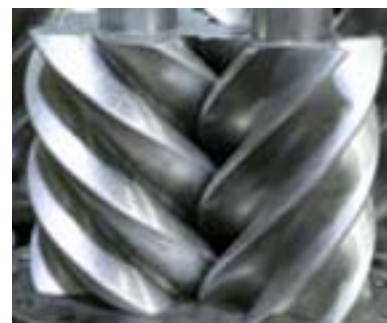
Obr. 3.16. Rotory šroubového čerpadla
