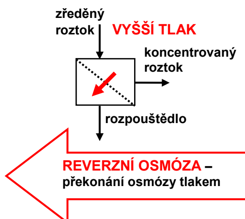
Obr.3.51. Principy osmózy a reverzní osmózy (membrána propouští jen rozpouštědlo)
