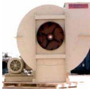
Obr. 3.22. Provozní ventilátor, d = 1,6 \text{ m} , N = 16 \text{ s}^{-1} , V' = 20 \text{ m}^3 \text{ s}^{-1} , \Delta p = 1,5 \text{ kPa}
