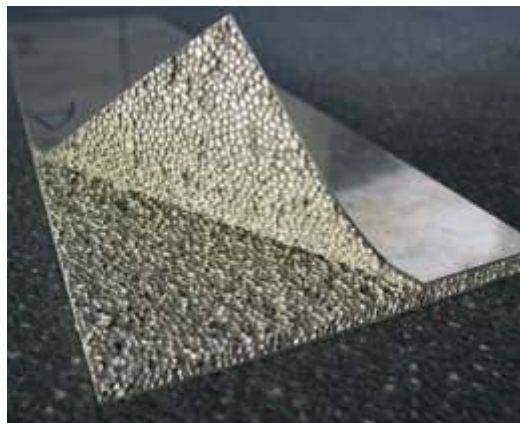
Obr.10.2 Sendvičový panel z kovové pěny.
