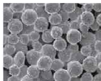
Obr.10.5 Bronzový slinutý prášek, tedy slinutý porézní materiál (tzv. kovová houba).
