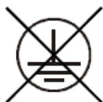
Obr. 5.4. Označení kovových částí na povrchu zařízení třídy II.
